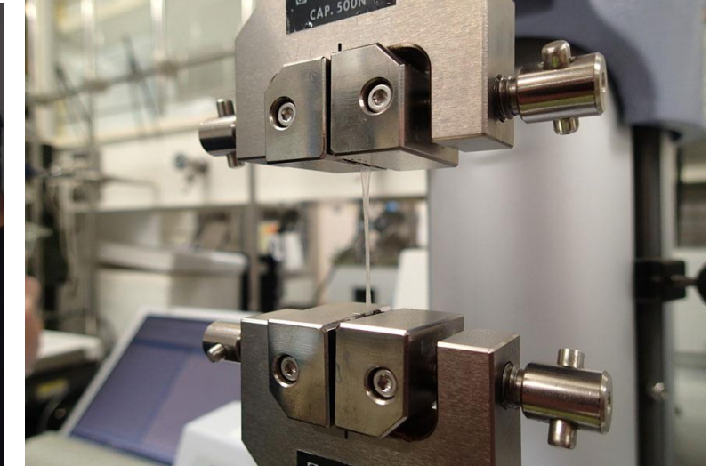
引張試験によるPRFの機械的強度評価の様子.
